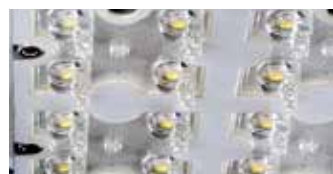
High-Power-LED-Modul mit bis zu 136 lm/W
