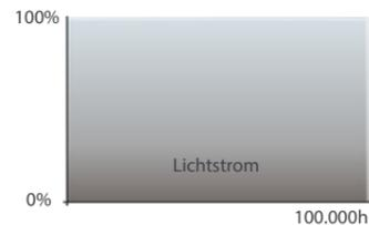
Moderne LED-Systeme arbeiten heutzutage allerdings so stabil, dass sie über die Lebensdauer nur noch wenige Prozent vom Lichtstrom verlieren. Hierbei ist der Einfluss des konstanten Lichtstroms eher gering.
